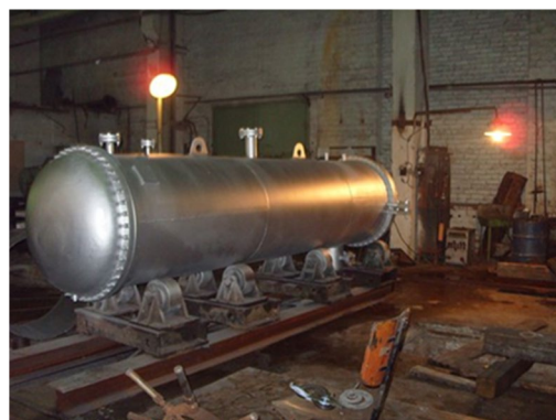
ООО «Усольехимпром» (Иркутская обл.): конденсатор аммиачный P = 1,5 МПа, T = 125 °С.
