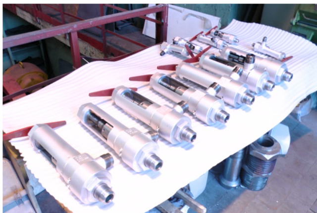
АО «Уральский компрессорный завод», г. Екатеринбург: разработка и производство арматуры высокого давления DN 10, 32 PN 320
