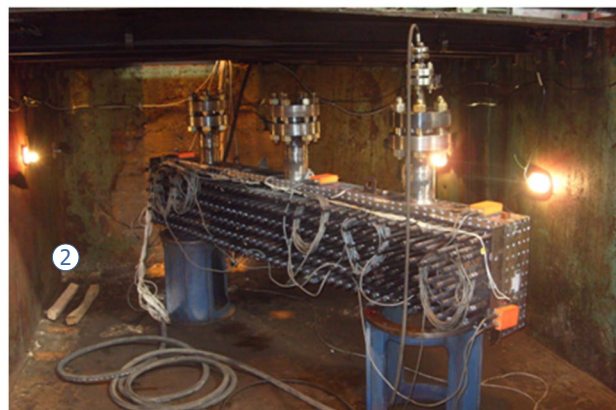
АО «Бормаш»: проведение испытаний на прочность до разрушения аппарата воздушного охлаждения высокого давления с коллекторами коробчатого типа (рабочее давление 25 МПа) с целью подтверждения теоретических исследований на прочность коробчатой конструкции аппарата (Программа NASTRAN).
