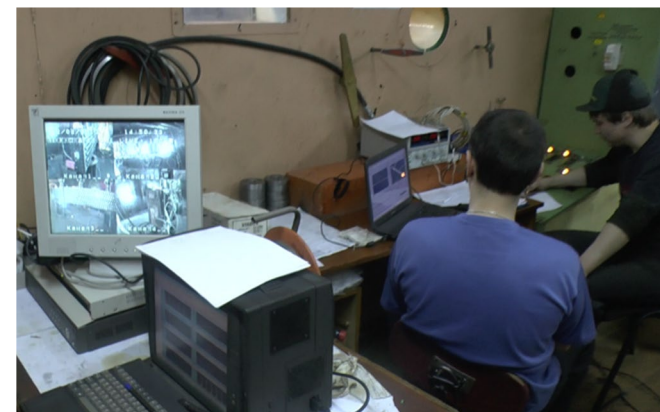
Станция дистанционного управления стендом высокого давления в режиме онлайн.
