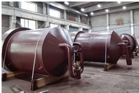
АО «Иргиредмет»: колонны для десорбции углей объемом 19,4 м/куб.
