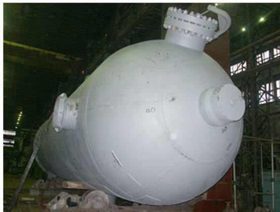
АО «ТольяттиАЗОТ»: проект сепаратора метанола для отделения жидкого метанола – сырца в агрегате производства метанола – D = 3100 мм, Р = 10 МПа.
