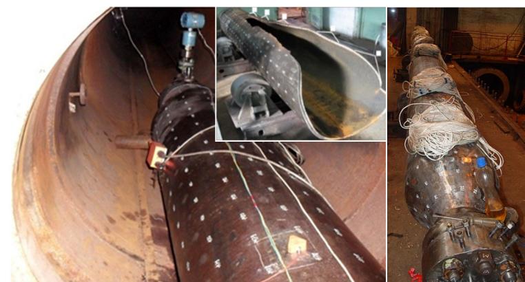
Исследования прочности сепаратора – маслоотделителя (Германия) проводились на специальном стенде высокого давления, оборудованном подземным защитным сосудом D 1200 мм и бетонным боксом. Стенд оснащен арматурой с дистанционно управляемыми клапанами и триплекс – насосом ф. Valcke. Разрушение произошло при подъеме давления до 112 МПа.
