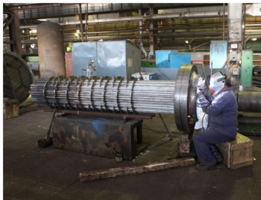
АО «АНХК»: проекты теплообменников Т-102 и Т-101 для нагревания циркуляционного водородсодержащего газа производства дизельного топлива P=10, 25\text{ МПа} , T=455^{\circ}\text{C} . Изготовитель ОАО «Волгограднефтемаш».
