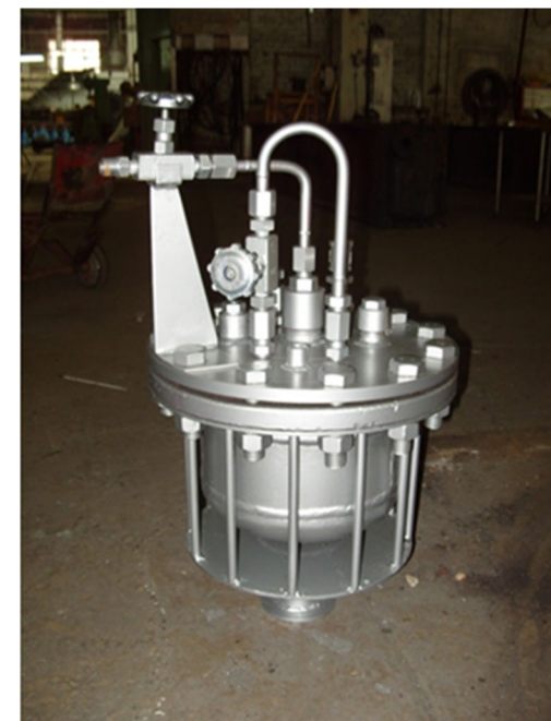
АО «Иргиредмет»: аппарат для десорбции золота в лабораторных условиях, емкость номинальная 0, 012 кв.м.
