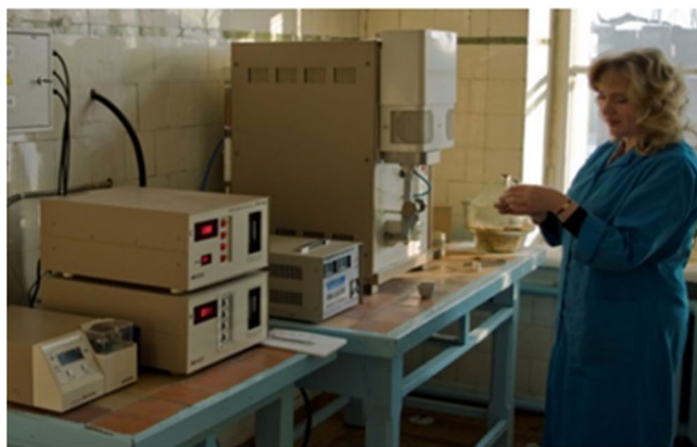
Определение содержания элементов (углерод и сера) в стали и чугуна на экспресс - анализаторе АУС – 81 -44
