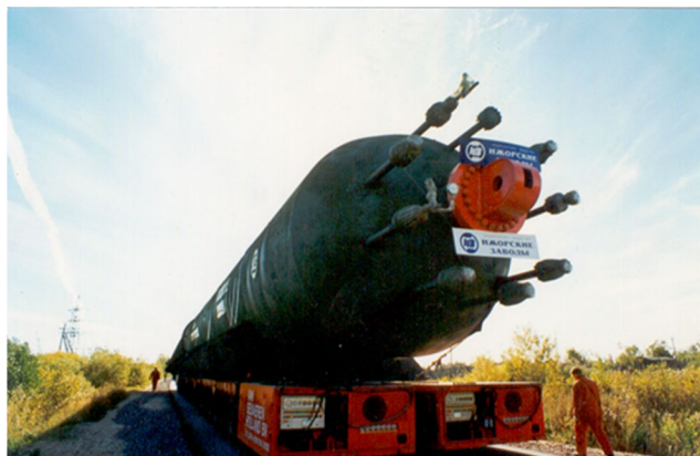
Совместно с институтом ВНИИПнефть и ПАО «Ижорские заводы» разработан для НПЗ ПАО «Лукойл-Пермнефтеоргсинтез» и запущен в производство реактор гидрокрекинга производительностью 3,0 млн. тонн нефти в год.
