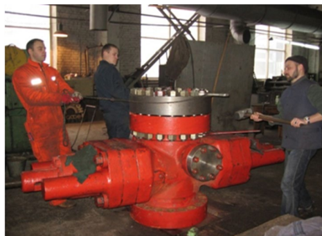
ООО «НафтаБурСервис», ООО «Интегра-Бурение», ООО «ИНК - Сервис» (Ирк. обл.): техническое диагностирование и техническое обслуживание противовыбросового бурового оборудования для герметизации устья нефтяных и газовых скважин.
