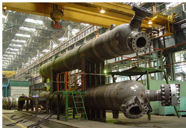
Разработаны, изготовлены и внедрены в производство модернизированные подогреватели воды одно- и двухкорпусные на давление 30 МПа и температуру 350 °С для агрегатов синтеза аммиака на АО «Невиномысском Азот», ЧАО «Северодонецком объединении Азот», ПАО «ТольятиАзот» и др.
