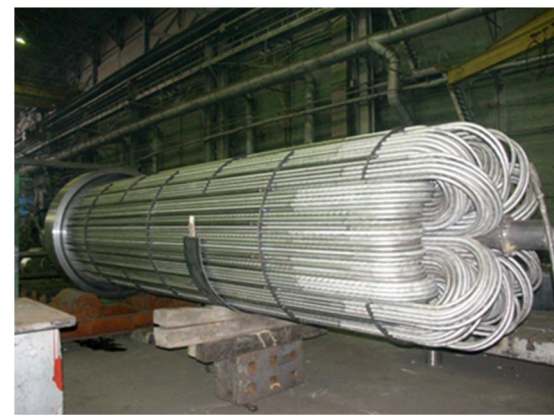
АО «ТольяттиАЗОТ»: проект U-образного пучка теплообменника высокого давления для технологической линии производства метанола.
