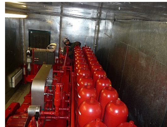
ЭПБ гидropневматических аккумуляторов установки БУ-Т400 на Верхнечонском нефтегазоконденсатном месторождении (Иркутская обл.) для КСА DEUTAG (Германия).
