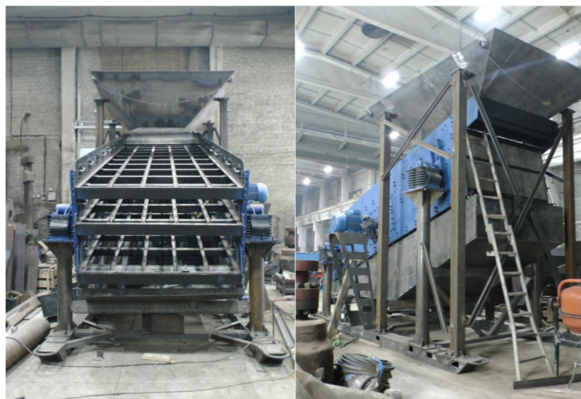
Модульная установка с отсадочной технологией обогащений для переработки песков россыпных месторождений
