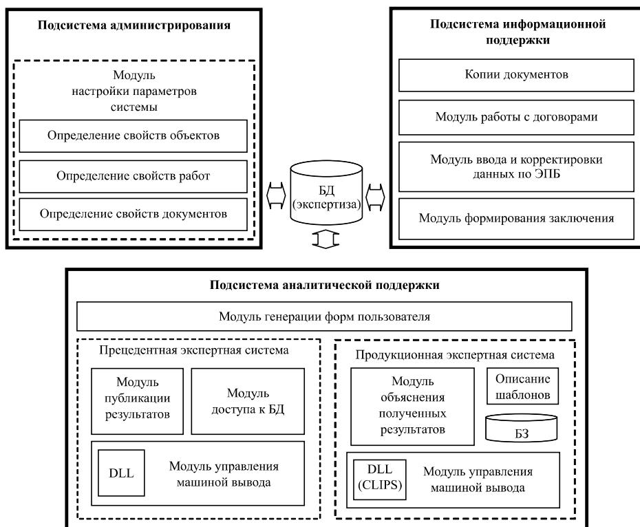
Рис. 5. Архитектура программной системы «Экспертиза ПБ»:
