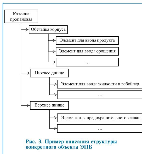
Рис. 3. Пример описания структуры конкретного объекта ЭПБ
